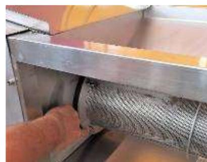
Im Zuge der Rückwärtsdrehung der Klobenspindel hat das zurückgedrückte Wachs vermutlich den Simmering zwischen dem Antrieb und der Klobenspindel beschädigt. Dieser muss dann ausgetauscht werden.
