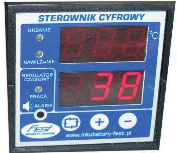
Das Einstellen eines negativen Hysteresewerts führt zum Rückwärtsbetrieb eines bestimmten Relais. Wenn Sie die negative Hysterese des Thermocontrollers einstellen, ändert sich sein Modus auf Heizung. Das Einstellen der negativen Hysterese des Feuchteregelelers ändert seinen Modus auf Befeuchtung
